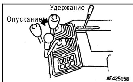
5. Заблокируйте рычаг управления стрелой ⑤ и рычаг управления ковшом ⑥ при помощи рычага блокировки ⑦.
